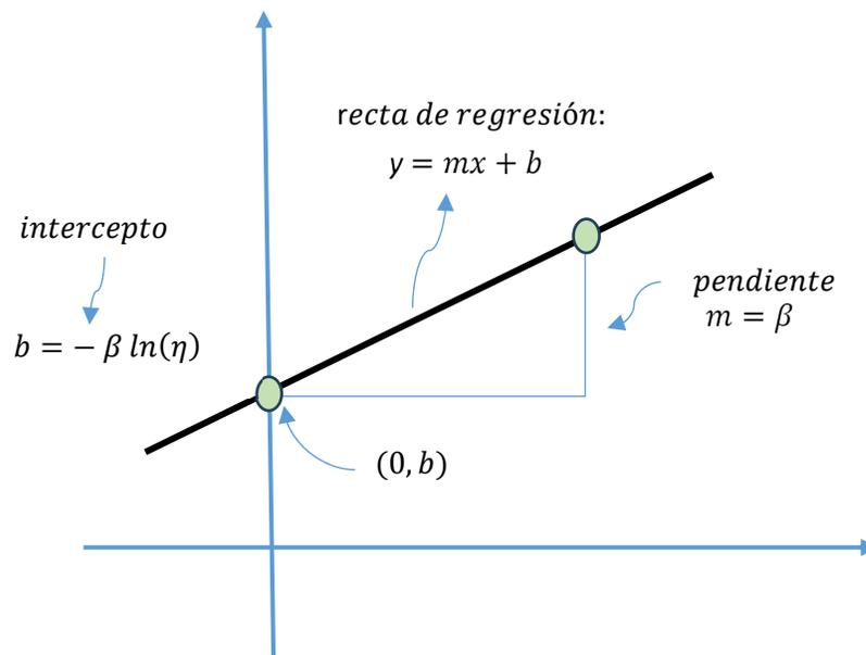
En la recta de regresión del Figura 4, destaca la pendiente  $m$ , que coincide con el parámetro de forma  $\beta$  y define la inclinación de la recta. Además, se observa un desplazamiento o intersección, denotado con el símbolo  $b$  que determina el punto donde la línea cruza el eje  $y$ , en el caso de la distribución de Weibull, esta intersección está en función de  $\beta$  y  $\eta$
