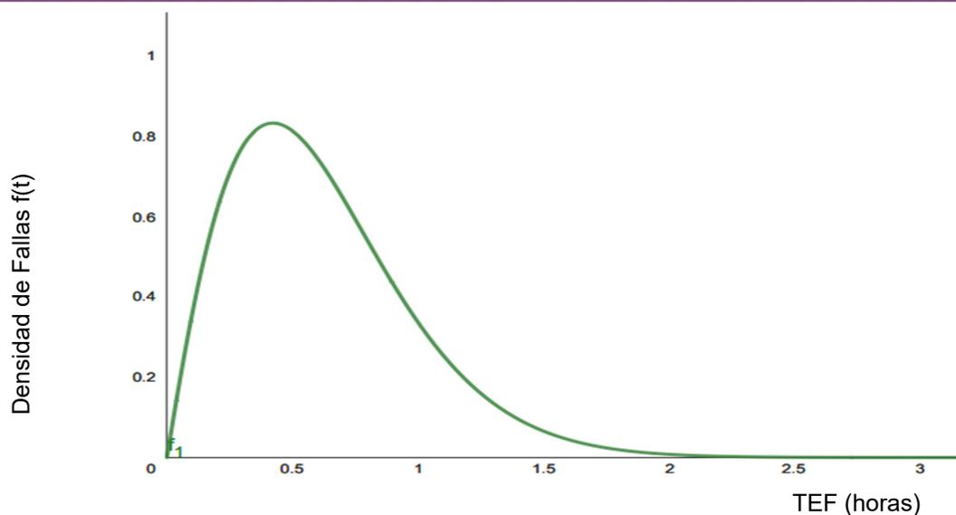
La figura 7 indica que la función de Weibull tiene un parámetro de forma mayor que 1 y un parámetro de escala menor que 1. Esto significa que la función de Weibull tiene un máximo en un punto dado y luego disminuye gradualmente a cero.
