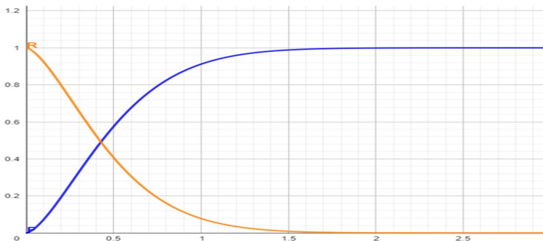
*Segunda aplicación de la distribución de Weibull es estimar el tiempo de reemplazo de un componente y sustituyendo los valores de los parámetros en la ecuación N° 10*
