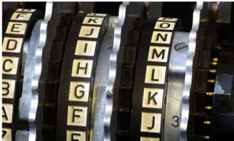
**ROTORES CON SUS ALFABETOS EN UNA MÁQUINA ENIGMA.
