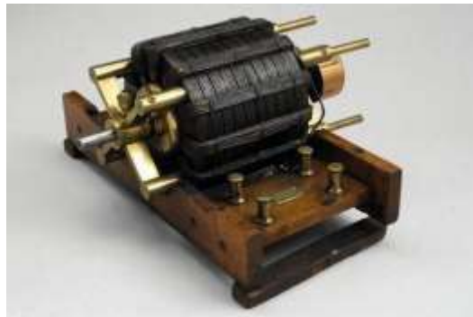
MODELO ORIGINAL DEL MOTOR DE INDUCCIÓN DE TESLA (1887). CRÉDITO IMAGEN: SCIENCE MUSEUM.
