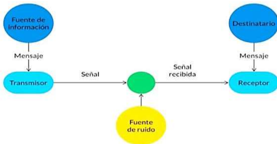
ESQUEMA DEL SISTEMA GENERAL DE COMUNICACIÓN DE CLAUDE SHANNON. FUENTE IMAGEN: WIKIMEDIA.
