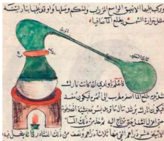
DIBUJO Y DESCRIPCIÓN DEL ALAMBIQUE, POR JABIR IBN HAYYAN EN EL SIGLO VIII. FUENTE IMAGEN: WIKIMEDIA.
