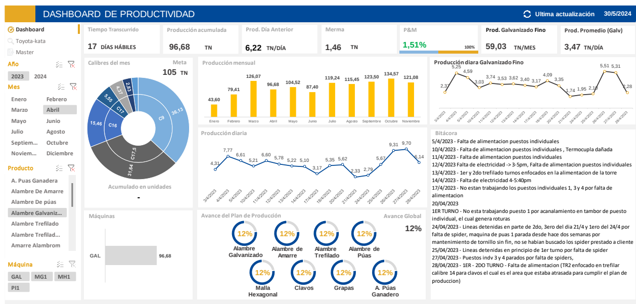
Figura 5. Tablero de indicadores de la línea de galvanizado
