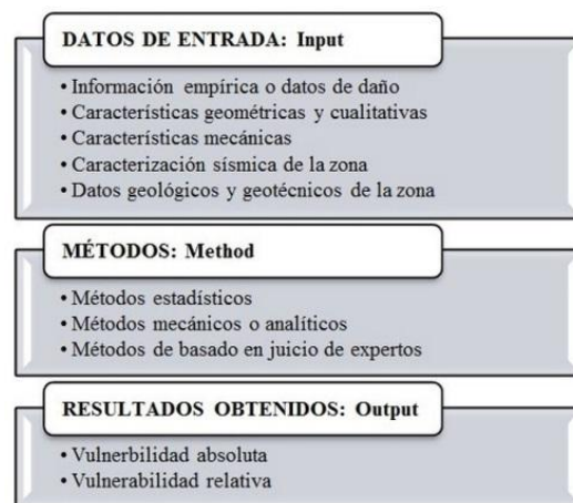
Figura 3. Clasificación de las técnicas de evaluación de la vulnerabilidad, (Dolce et al. 1994).
