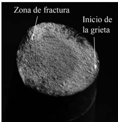
Figura 5: Macrofotografía de Acero AISI 1045. Condición normalizado sometidas a fatiga de alto ciclaje ( S=234 MPa).
