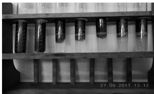
Figura 2: Prueba de estabilidad de una emulsión agua en crudo. Fuente: Silva, 2012 [27].
