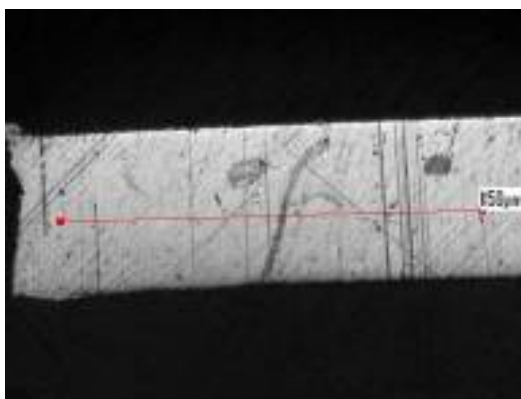
Figura 8: Disposición, forma y tamaño de inclusiones obtenidas del transformador fallado por Sobretensión en la bobina de alta tensión 100X. (cara longitudinal)
