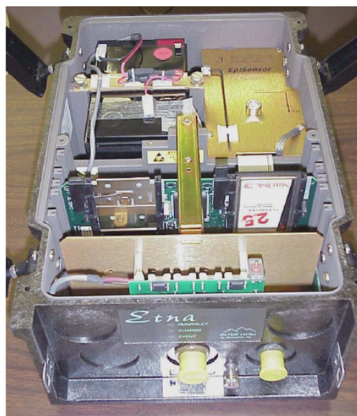
Figura 3: Vista Interna de un Acelerógrafo Etna con EpiSensor Interno
