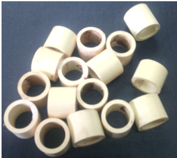
Figura 2: Medio de soporte de los DI-FAFS.
