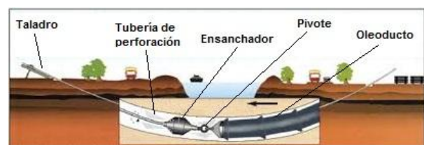
Figura 4: Esquema representativo del proceso de instalación de la tubería en la perforación previamente ensanchada.
