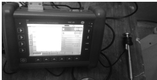
Figura 2: Durómetro portátil Krautkramer MIC20.
