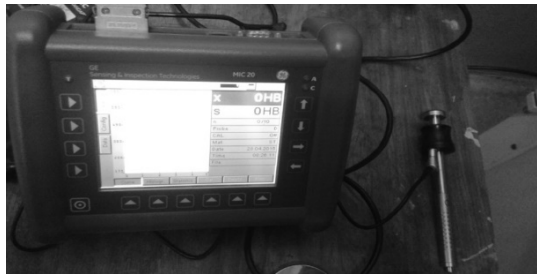
Figura 2: Durómetro portátil Krautkramer MIC20.
