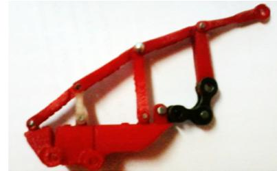
b) Impresión 3D del mecanismo en material PLA (Poliácido láctico)
