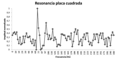
Se muestran las amplitudes relativas de la oscilación, medida con el sensor de vibración LDT0 028 K (S), para una frecuencia de resonancia de 74 Hz.
