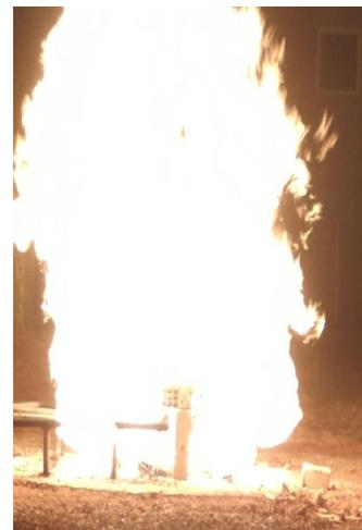
Figura 4: Ensayo de exposición al fuego de losas.
