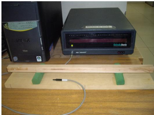
Figura 1: Dispositivo para pruebas no destructivas de flexión por vibraciones transversales y aparato *Grindosonic*<sup>®</sup>.
