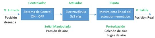
Figura 6: Diagrama de bloques del sistema de control en lazo abierto.
