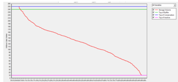
Figura 18: Volúmenes Almacenados en Lagunillas, Operando Lagunillas, y reservorio Verde y con las demandas planteadas (100 %), con CANESM2-RCP4.5 reservorio VERDE
