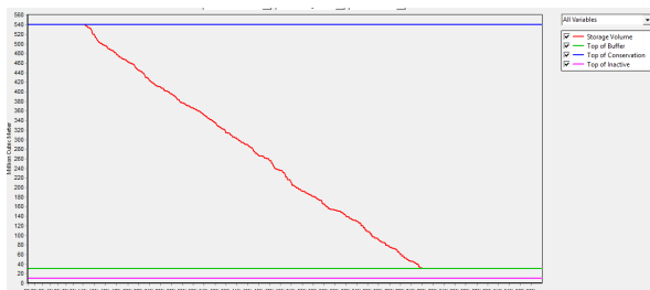
Figura 9: Volúmenes Almacenados operando y trasvasando del rio Verde a Lagunillas y con las demandas planteadas (100 %)
