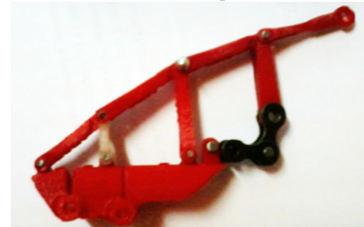
b) Impresión 3D del mecanismo en material PLA (Poliácido láctico)
