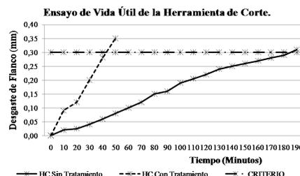
Figura 4: Ensayo de VUHC (S/T) y (C/T).
