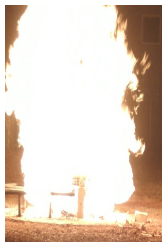
Figura 4: Ensayo de exposición al fuego de losas.
