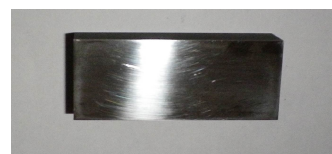
(a) Probeta A usada para el ensayo de picadura, de 20x50 mm, con espesor de 10 mm
