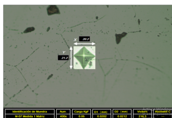
Figura 10: Medición de dureza en la matriz de la muestra C.
