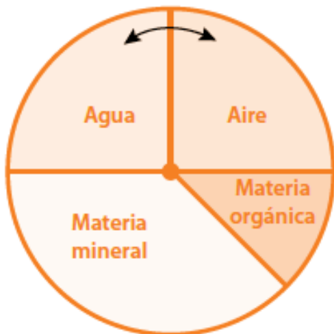
Figura 1: Representación esquemática por volumen de un suelo de textura media [6]
