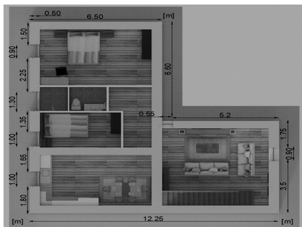
Figura 10: Vista en planta, primer piso de vivienda unifamiliar con muro de fardos de paja
