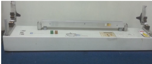
Figura 2: Puente Kelvin Marca: Aesa Cortailod, Modelo 7106.
