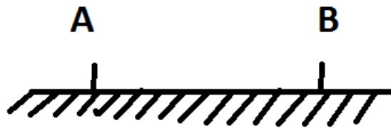
Figura 2: Medición de resistencia en dos puntos separados del suelo
