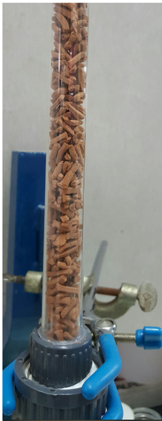
Figura 4: Columna empacada con arcillas (filtro coalescedor)
