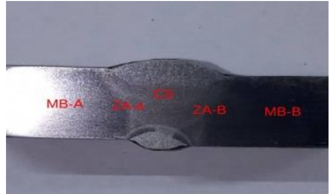
Figura 10. Identificación de zonas en la probeta para el ensayo de microdureza
