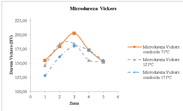
Figura 11. Microdureza Vickers para cada condición de soldadura
