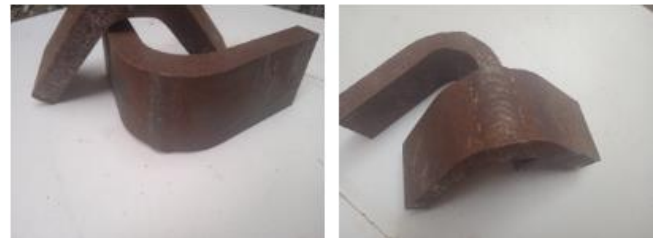
Figura 9. Probetas de ensayo de doblado de la condición a 171^\circ\text{C}
