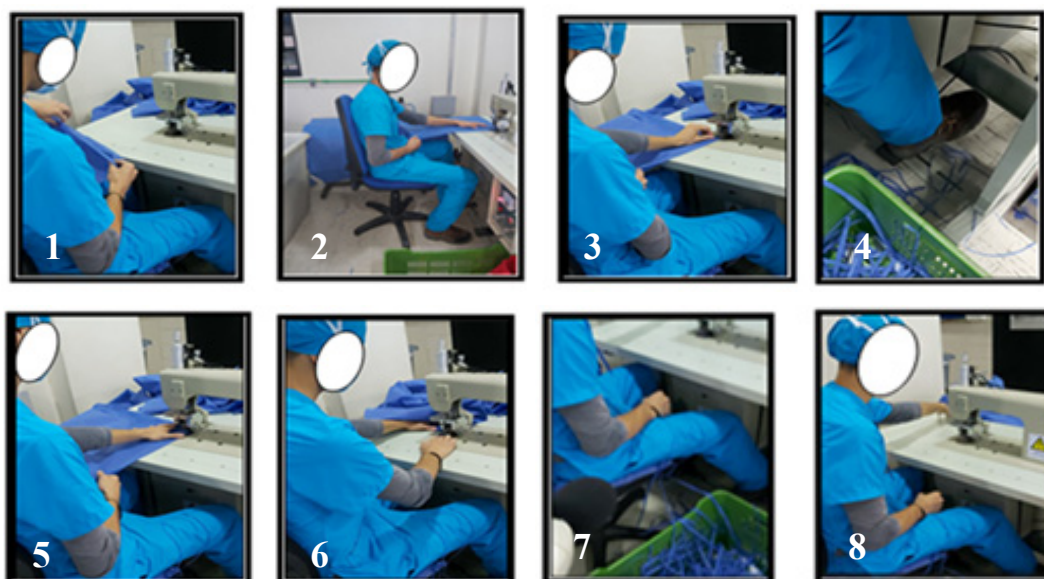
Figura 1. Actividad de trabajo de coser pierneras. Máquina de ultrasonido. Empresa de manufactura. Caracas. Venezuela 2024 (n=29)
