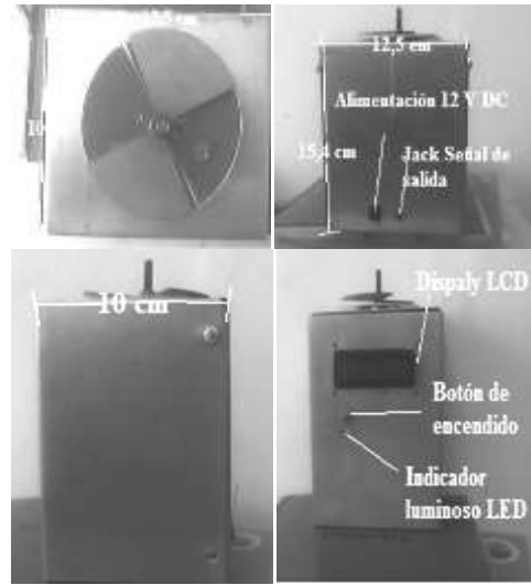
Fig. 8: Dimensiones y partes del prototipo de Molino de campo. (Fuente Propia)
