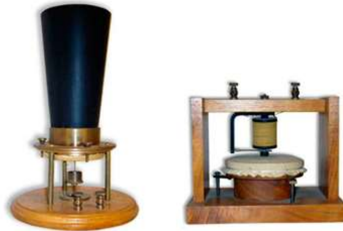
TRANSMISOR LÍQUIDO Y RECEPTOR USADO POR BELL (RÉPLICA DEL INTENTO DE 1876). IMAGEN CORTESÍA DE SPARK MUSEUM.
