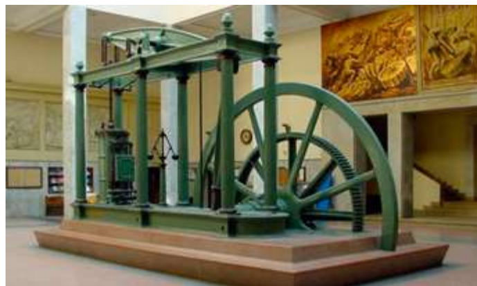
UNA MÁQUINA DE VAPOR DE TIPO WATT, CONSTRUIDA POR D. NAPIER AND SON (LONDRES) EN 1859. CRÉDITO IMAGEN: NICOLÁS PÉREZ.
