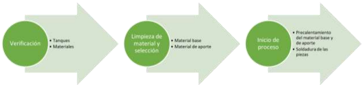
Figura 4. Proceso de soldadura oxiacetilénica
