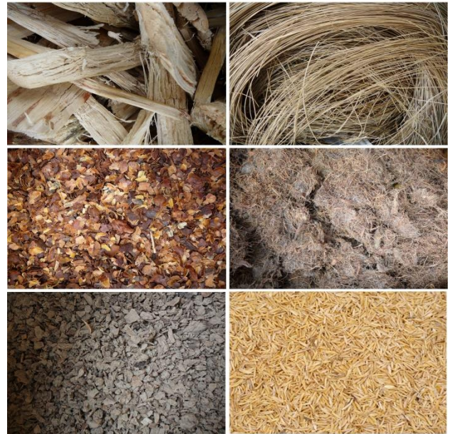
Figura 1. Biomasa de bagazo, pajonal, cacao mineralizado con cemento, raquis de palma, cascarilla de café, y cascarilla de arroz.
