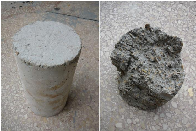
Figura 8. Probeta de composite formado por cemento, arena y cascarilla de arroz
