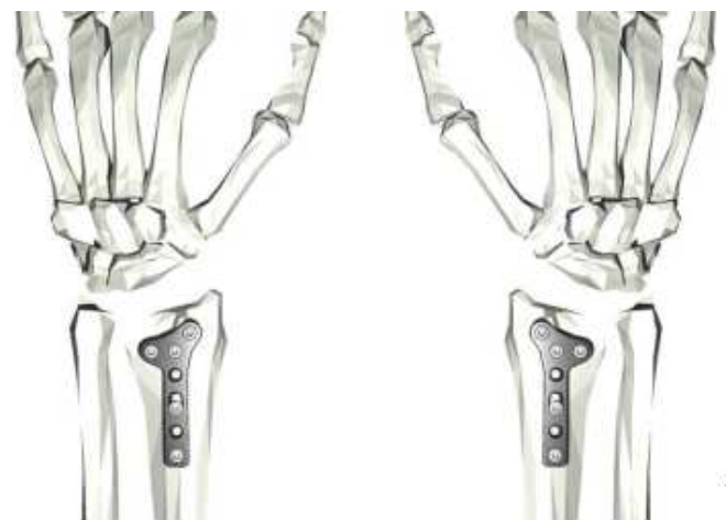
Figura 3: Ubicación de la placa: (a) Diseño original–brazo izquierdo, (b) Diseño simétrico–brazo derecho .
