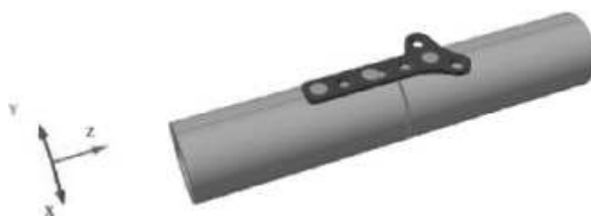
Figura 5: Sistema analizado placa–hueso–tornillos de fijación.
