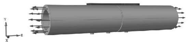
Figura 8: Esfuerzo de tracción generado en la sección transversal del hueso cortical.
