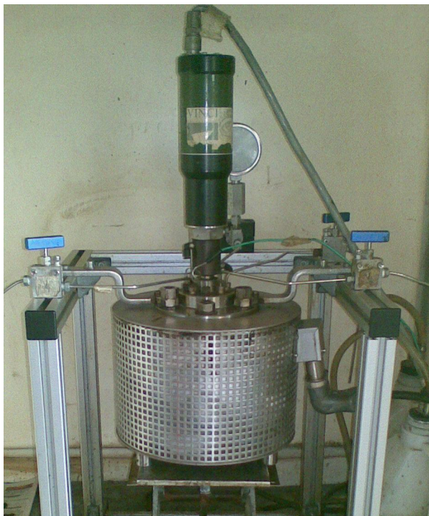
Figura 1: Reactor por carga de cabezal fijo de acero inoxidable de 100 mL con agitación mecánica marca Technology
