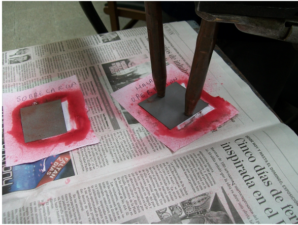
Figura 2: Imanación por electrodos de la chapa de acero al momento de aplicar corriente magnetizante.
