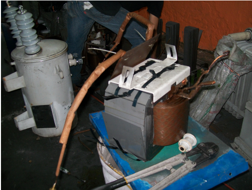
Figura 1: Partes constitutivas del núcleo de un transformador de distribución.
