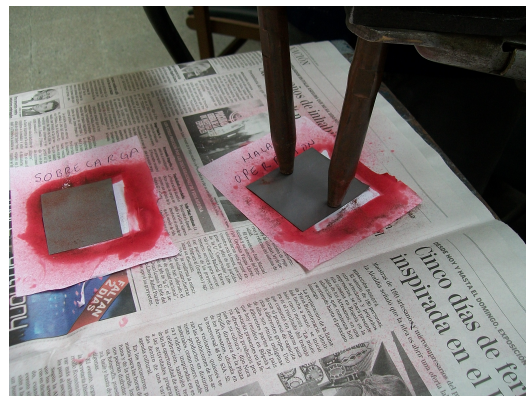
Figura 1: Imanación por electrodos de la chapa de acero al momento de aplicar corriente magnetizante
