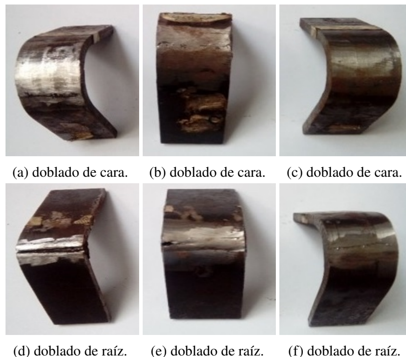
Figura 21: Probetas con 4 cordones de soldadura
