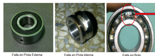
Figura 9: Fallas en los cojinetes [13]
